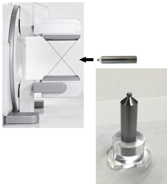
図5 NIST トレーサブル<sup>57</sup>Co 密封点線源
